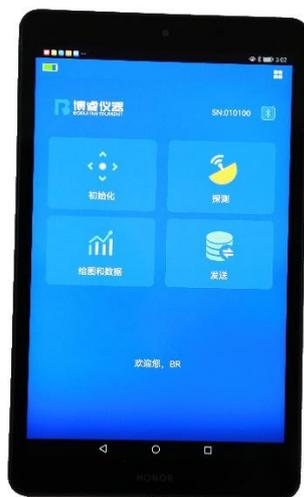
适应安卓系统智能平板或手机，具有探测模式设置、测斜数据采集，数据图形绘制、查看，数据导出共享与实时同步等功能，配合接入博
