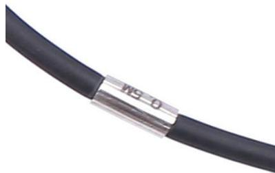
4 芯屏蔽电缆具有凯夫拉应力部件和 PU 护套，每 0.5m 有一个标有深度数字标记的不锈钢卡扣，深度间隔从探头的顶部测轮开始。
